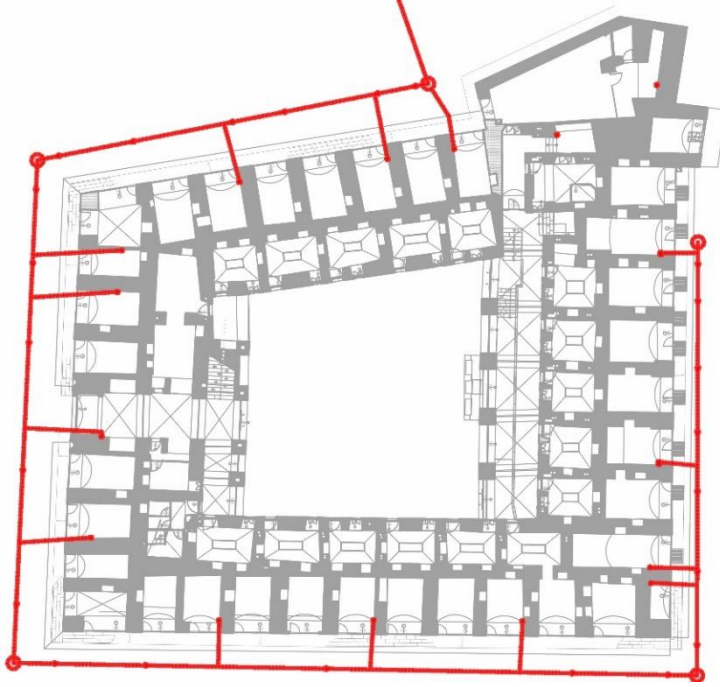
Şekil 5. Restorasyon sonrası eklenen ıslak mekanlar için pis su gideri(Tokat Vakıflar Bölge Müdürlüğü arşivinden alınan planlar tarafımızca düzenlenmiştir)
